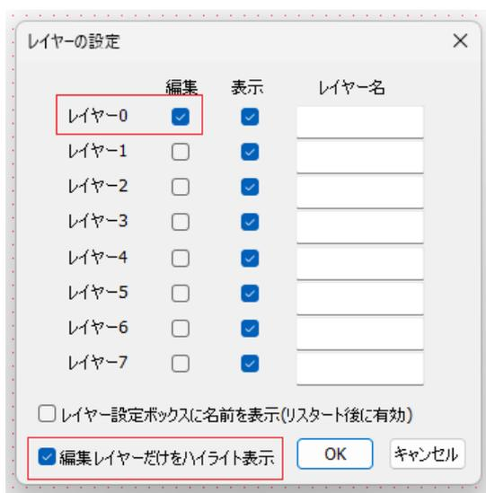
レイヤー0に作図、本ソフトがレイヤー5にタグ接続先情報を書きこんだ状態でBSch3Vのレイヤー設定で、「編集レイヤーだけをハイライト」にしていると下図のような表示になります。
